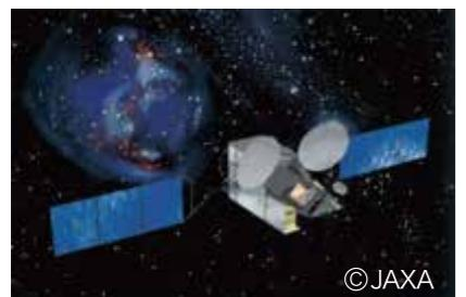
「きずな」はKa帯による高速衛星通信システム構築に関する技術実証を行うための人工衛星で、NICTが開発した再生交換機が搭載され、各種衛星通信実験に使用されました。東日本大震災や熊本地震の際には被災地での通信支援を行ったほか、スーパーハイビジョン伝送実験や3.2Gbps伝送実験などの成果を残しました。
